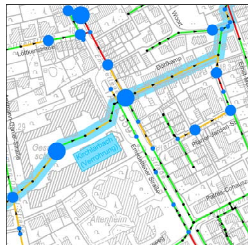
Überlastete Regenwasserkanalisation und Gewässerverrohrung
